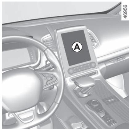
Air conditionné en fonctionnement, depuis l'écran multimédia **A**, sélectionnez « Véhicule », « Qualité de l'air ».
