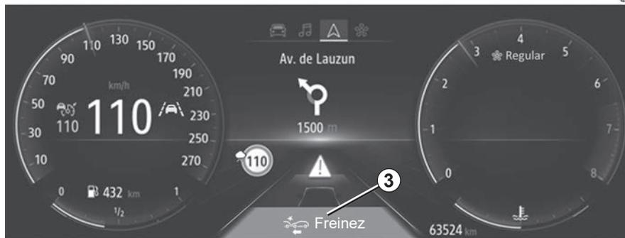
Si le freinage actif d'urgence a provoqué l'arrêt du véhicule, le maintien du véhicule à l'arrêt doit être réalisé par le conducteur en maintenant son pied sur la pédale de frein.
