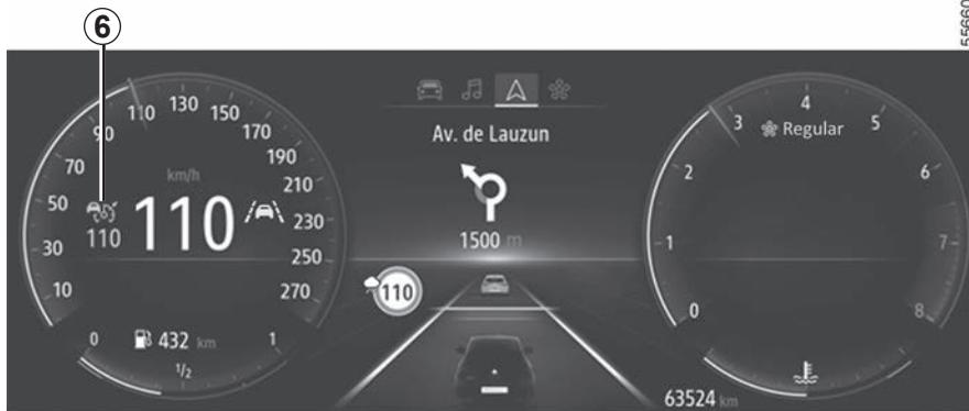
L'extinction du témoin **6** au tableau de bord confirme l'arrêt de la fonction.
