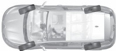
Lors de roulage à vitesse plus élevée, les roues arrière s'orientent dans le même sens que les roues avant (figure **B**) afin d'optimiser la stabilité du véhicule. Ceci est utile lors d'un changement de voie, lors de la prise de virage...
