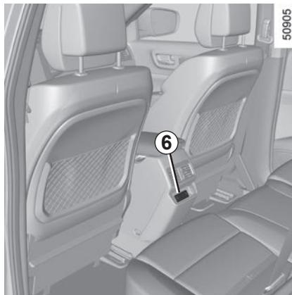
Les prises USB permettent également de recharger des accessoires agréés par les Services techniques de la marque et dont la puissance nominale ne dépasse pas 10,5 watt (tension 5 V) par prise.
