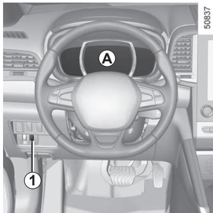
**Tableau de bord A** : s'allume à l'ouverture de la porte conducteur. Contact mis, tournez la molette **1** pour régler l'intensité lumineuse du tableau de bord.
