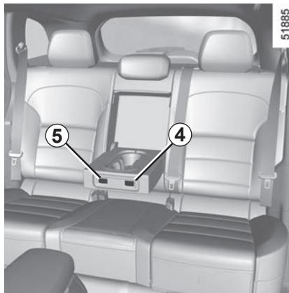
Selon le véhicule, si vous abaissez l'accoudoir des sièges arrière, vous remarquez la présence d'un contrôleur de dispositif de chauffage des sièges arrière sur l'accoudoir arrière.
