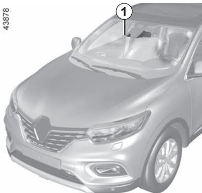
L'alerte de survitesse avec reconnaissance des panneaux de signalisation informe le conducteur du dépassement de la limitation de vitesse sur la portion de route sur laquelle il se trouve.
