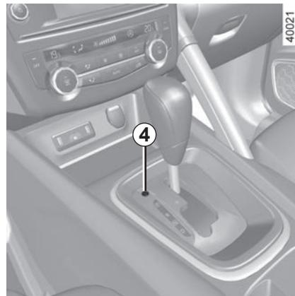
**À la mise en route**, dans le cas où le levier est bloqué sur **P** alors que vous appuyez sur la pédale de frein, il y a possibilité de libérer manuellement le levier. Pour cela, passez un outil (tige rigide) dans la fente **4** afin de déverrouiller le levier.
