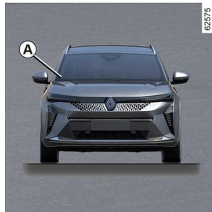
Le QR Code figurant sur l'étiquette A permet aux professionnels de secours au moyen d'une tablette ou d'un smartphone, d'accéder immédiatement aux informations techniques utiles
