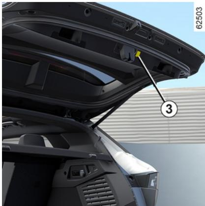
Lorsque le hayon détecte un obstacle durant sa manœuvre, celui-ci s'arrête. Il se libère ensuite de l'obstacle par un mouvement en sens inverse, de faible amplitude, puis s'arrête complètement.
