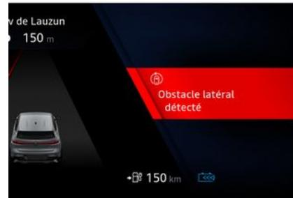
En roulage (vitesse comprise entre 65 km/h et 180 km/h environ), en cas d'approche d'une ligne (continue ou discontinue), lorsqu'il y a un risque de collision avec un véhicule qui se trouve dans la zone d'angle mort **D** et se déplace dans la même direction que votre véhicule ou avec un véhicule qui s'approche rapidement par l'arrière sur une voie adjacente dans le périmètre de détection **E**, le système :
