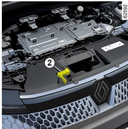
Levez le capot de quelques centimètres et poussez le levier **2** vers la gauche.
