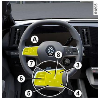
**3.** Contacteur de sélection/désélection des assistances de conduite, suivant véhicule :
