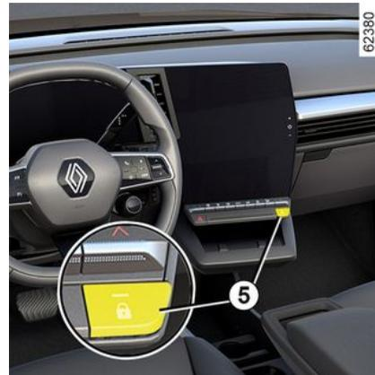
Le contacteur **5** commande simultanément les portes et le coffre.
