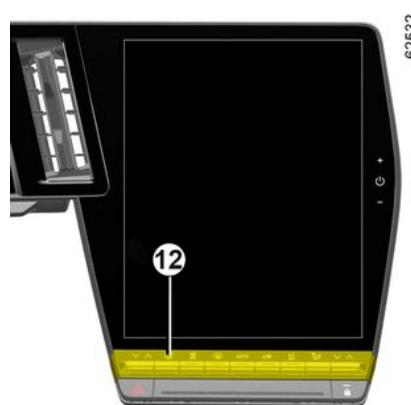
Pour contrôler le débit des aérateurs **1** et **3** appuyez ou levez sur la commande **12** en fonction de l'ouverture souhaitée.
