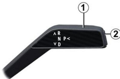
Véhicule à l'arrêt, moteur allumé ou contact mis, appuyez sur le bouton 2 pour engager la position P.
