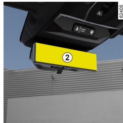
À la mise sous contact du véhicule, le rétroviseur 2 fixé sur la console centrale de pavillon affiche l'environnement arrière transmis par la caméra 1.
