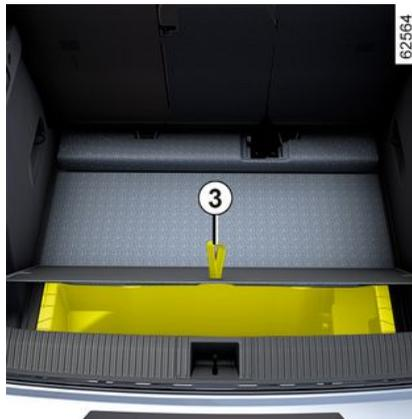
Ce bac est destiné aux cordons de charge. La charge maximale admissible par le bac est de 15 kg.
