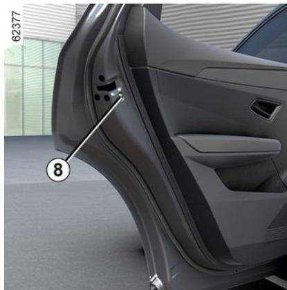
Pour rendre impossible l'ouverture des portes arrière de l'intérieur, baissez le levier **8** et vérifiez de l'intérieur que les portes sont bien condamnées.
