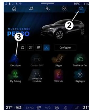
Véhicule à l'arrêt, moteur allumé, depuis le Monde « Véhicule » **2** de l'écran multimédia **1**, appuyez sur le menu « Électrique » **3** pour paramétrer la programmation de charge et/ou de confort de votre véhicule.
