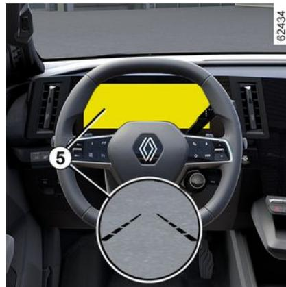
Fonction activée, le témoin
