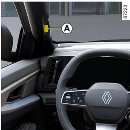
Après avoir enregistré votre profil depuis le système multimédia, il est possible lorsque vous entrez dans le véhicule de rappeler les réglages utilisateurs du conducteur (position de conduite...) à l'aide de la caméra **A**.
