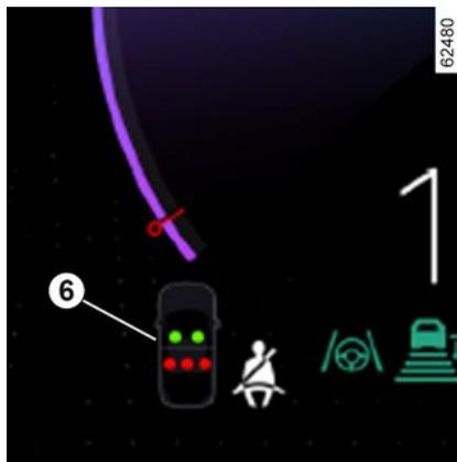
Portes fermées, le visuel **6** s'affiche au tableau de bord à la mise sous contact du véhicule pendant 60 secondes environ. Il indique au conducteur l'état de bouclage de chacune des ceintures à chaque :
