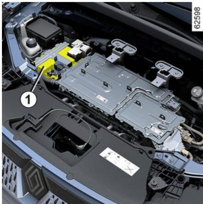
La batterie secondaire est une batterie 12 volts : elle fournit l'énergie nécessaire au fonctionnement des équipements du véhicule (feux, essuie-vitres, système audio...) et de certains systèmes de sécurité tels que l'assistance de freinage.
