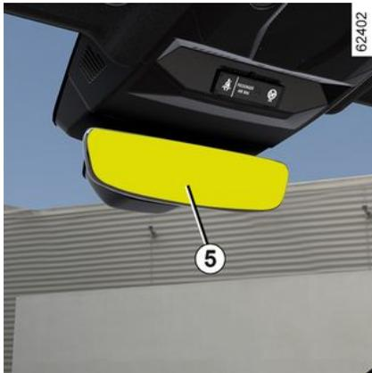
Le rétroviseur fonce automatiquement lorsque vous êtes suivi par un véhicule éclairé ou en cas de forte luminosité.
