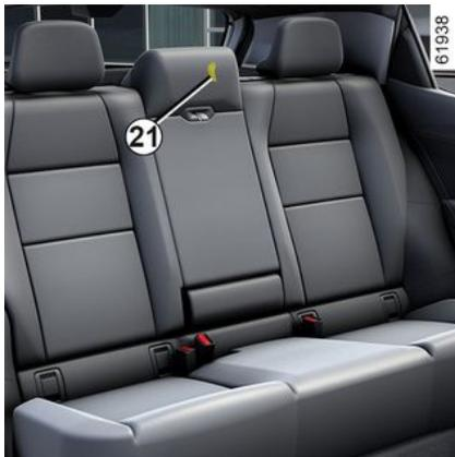
sur la sangle **21** situé derrière l'appui-tête central pour abaisser le siège central.
