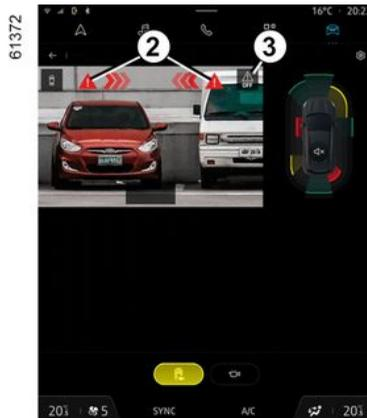
Si le véhicule est équipé d'un attelage reconnu par le système et qu'une remorque a été connectée, le freinage actif d'urgence en marche arrière est automatiquement désactivé et le message suivant s'affiche au tableau de bord : « Remorque: capteurs parking indisponibles », accompagné du témoin
