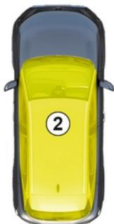
**Moteur allumé**, si après avoir ouvert et fermé une porte, la carte n'est plus dans la zone **2**, le message « Carte non détectée » vous alerte que la carte n'est plus dans le véhicule. Cela permet d'éviter, par exemple, de partir après avoir déposé un passager avec la carte sur lui.
