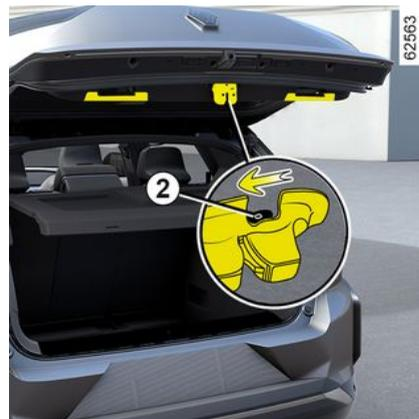
En cas d'impossibilité de déverrouillage du coffre, il est possible de le faire manuellement de l'intérieur :
