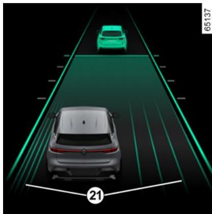
Pour activer l'ajustement de la position dans la voie, la fonction « Centrage voie » doit être en régulation avec le témoin **22** affiché en vert au tableau de bord et la vitesse du véhicule inférieure à 50 km/h.
