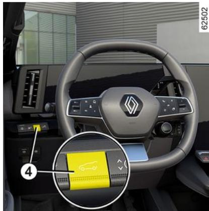
Pour déclencher l'ouverture du hayon, faites un appui long sur le contacteur **4** jusqu'au signal sonore puis relâchez immédiatement le contacteur.
