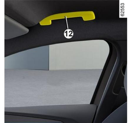
Elle sert à se maintenir en roulage. Ne l'utilisez pas pour monter dans le véhicule ou en descendre.
