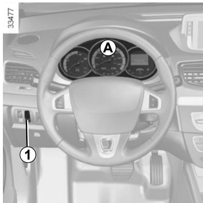
**Tableau de bord A** : il s'éclaire à l'allumage des feux. Vous pouvez en régler l'intensité lumineuse en tournant la molette 1.
